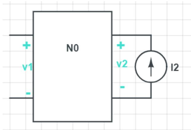
$$\begin{bmatrix} V_1 \\ V_2 \end{bmatrix} = \begin{bmatrix} z_{11} & z_{12} \\ z_{21} & z_{22} \end{bmatrix} \begin{bmatrix} I_1 \\ I_2 \end{bmatrix}$$
