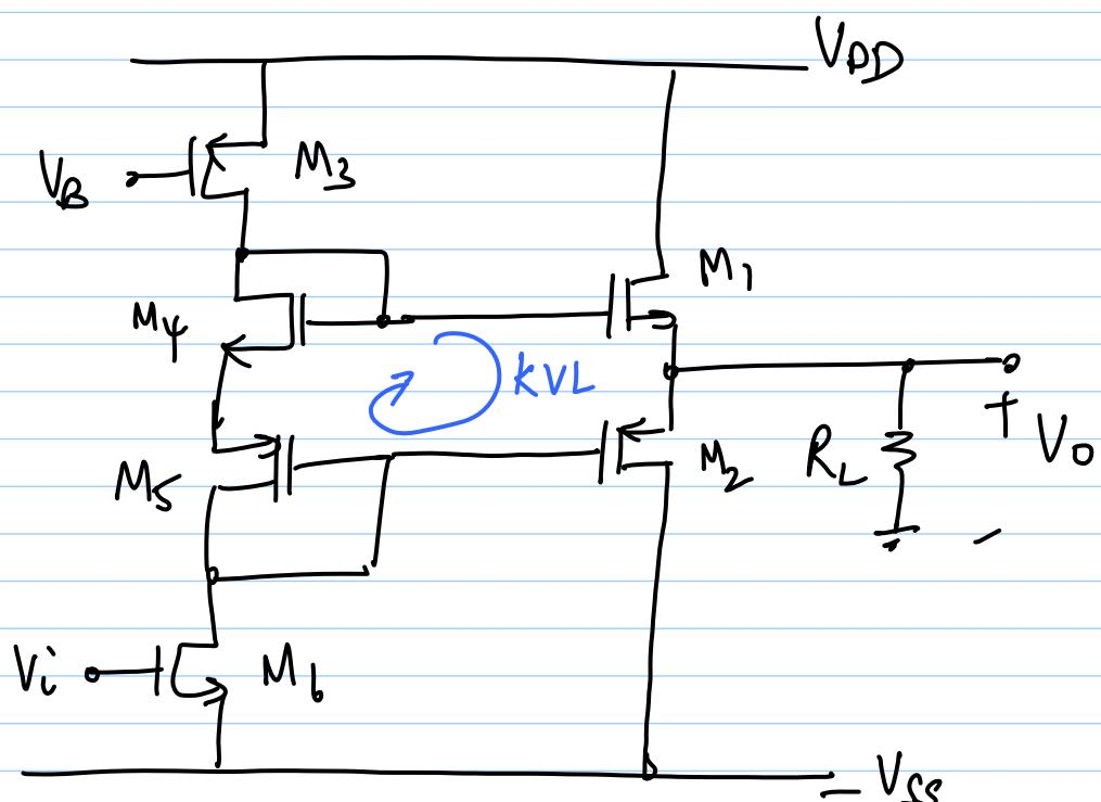
$$\underline{\text{KVL}} \quad V_{S_{15}} + V_{A_{54}} = V_{G_{S1}} + V_{G_{2}}$$
