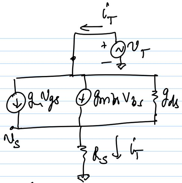
$$i_T = g_m v_{gs} + g_{mbs} v_{bs} + (v_T - v_s) g_{ds}$$
