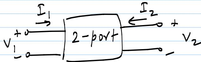
$$\begin{bmatrix} V_1 \\ V_2 \end{bmatrix} = \begin{bmatrix} Z_{11} & Z_{12} \\ Z_{21} & Z_{22} \end{bmatrix} \begin{bmatrix} I_1 \\ I_2 \end{bmatrix}$$
