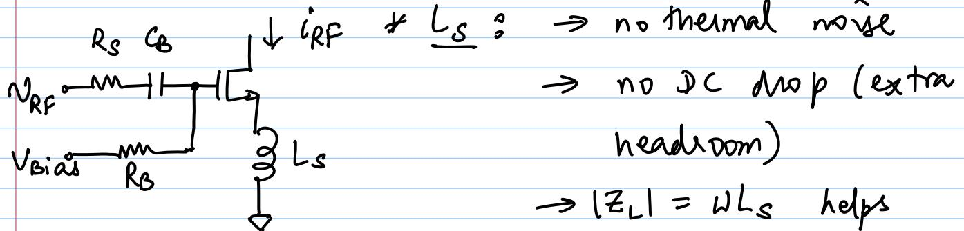
\*  $V_{\text{Bias}}$  → sets  $I_{\text{DC}}$
