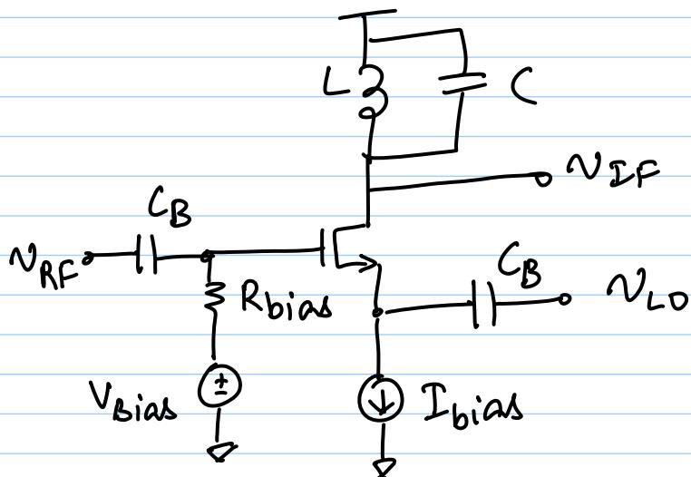
\*  $V_{GS} = V_{RF} - V_{LO}$
