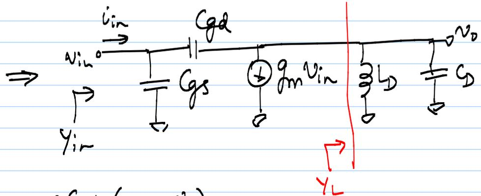
$$\begin{cases} i_{in} = sC_{gs}v_{in} + sC_{gd}(v_{in} - v_o) \\ sC_{gd}(v_{in} - v_o) = g_m v_{in} + v_o \cdot Y_L \end{cases}$$
