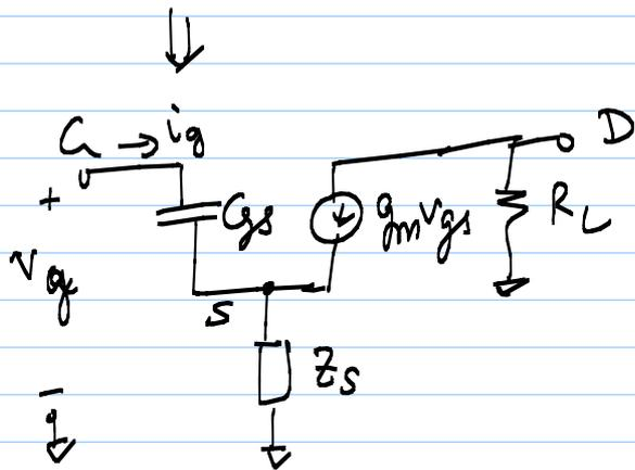
$$\frac{v_g - v_{gs}}{Z_s} = g_m v_{gs} + i_g$$
