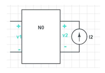
$\begin{bmatrix} V_1 \\ V_2 \end{bmatrix} = \begin{bmatrix} z_{11} & z_{12} \\ z_{21} & z_{22} \end{bmatrix} \begin{bmatrix} I_1 \\ I_2 \end{bmatrix}$
