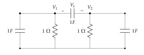
$$\begin{bmatrix} 2s+1 & -s \\ -s & 2s+1 \end{bmatrix} \begin{bmatrix} V_1 \\ V_2 \end{bmatrix} = \begin{bmatrix} a \\ b \end{bmatrix}$$
