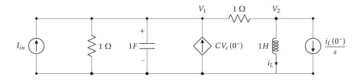
$$\begin{bmatrix} s+2 & -1 \\ -1 & 1/s+1 \end{bmatrix} \begin{bmatrix} V_1 \\ V_2 \end{bmatrix} = \begin{bmatrix} I_{in} + CV_c(0^-) \\ -i_L(0^-)/s \end{bmatrix}$$
