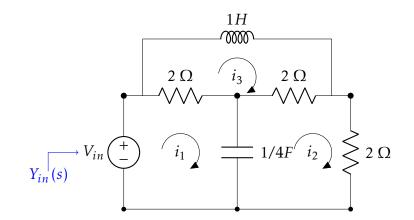
$$\begin{bmatrix} 2(s+2/s) & -4/s & -2\\ -4/s & 4\frac{s+1}{s} & -2\\ -2 & -2 & 4+s \end{bmatrix} \begin{bmatrix} I_1\\ I_2\\ I_3 \end{bmatrix} = \begin{bmatrix} V_{in}\\ 0\\ 0 \end{bmatrix}$$
