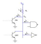
$$V_{CC} - I_L R_L \le V_{OL,max}$$
