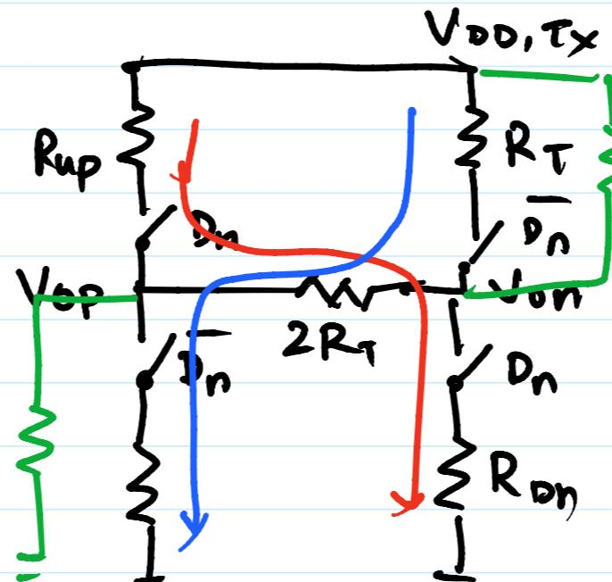
$$V_{op} - V_{on} = \pm \frac{V_{DD,Tx}}{2}$$
