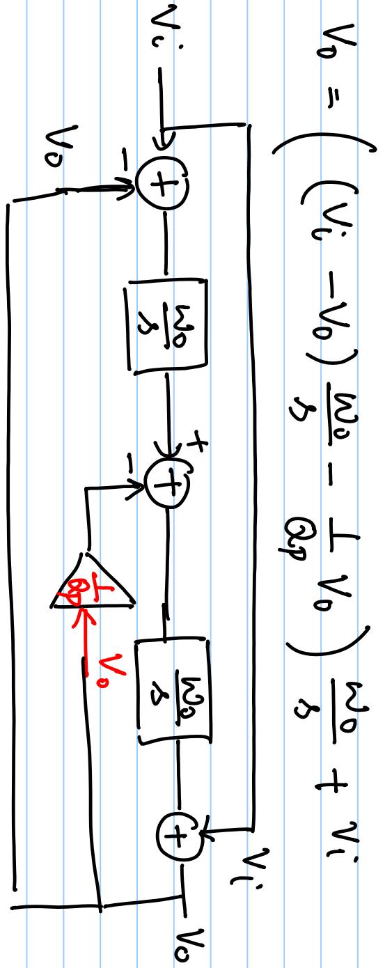
$$V_o = \left( (V_i - V_o) \frac{\omega_0}{s} - \frac{1}{Q_p} V_o \right) \frac{\omega_0}{s} + V_i$$
