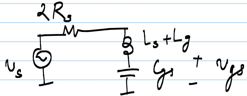
$$v_{gs} = Q_{in} \cdot v_s = 2 Q_{in} \cdot v_{in}$$
