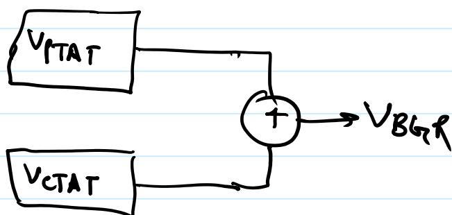
$$V_{BGR} = V_{PTAT} + V_{CTAT}$$
