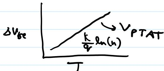
$$V_{BG} = V_{CTAT} + V_{PTAT}$$
